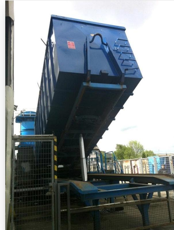
Selbst entwickeltes System, um Container sicher und schnell zu entladen und sortieren.
